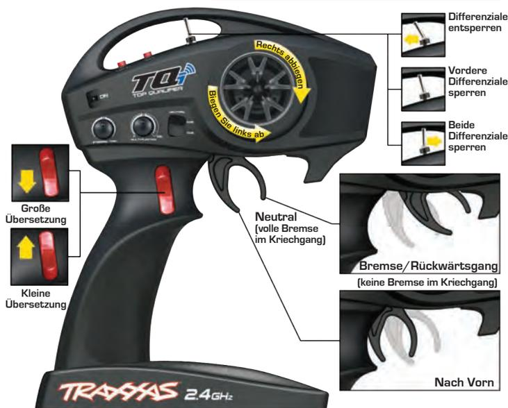
**Hinweis:** Bringen Sie den Hebel am Sender in die Nullposition und schieben Sie ihn erneut nach oben, um Rückwärtsfahren zu aktivieren, sofern sich der elektronische Geschwindigkeitsregler nicht im Kriechgangmodus befindet (weitere Informationen im Abschnitt: "Einen Gasmodus auswählen").
