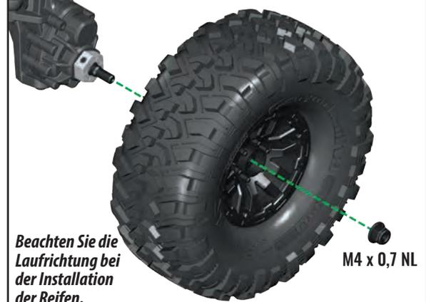
*Beachten Sie die Laufrichtung bei der Installation der Reifen.*
