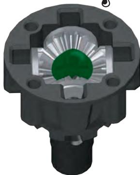
2 Differentialausgangszahnrad (kurz) Tragen Sie eine dünne Schicht auf.
