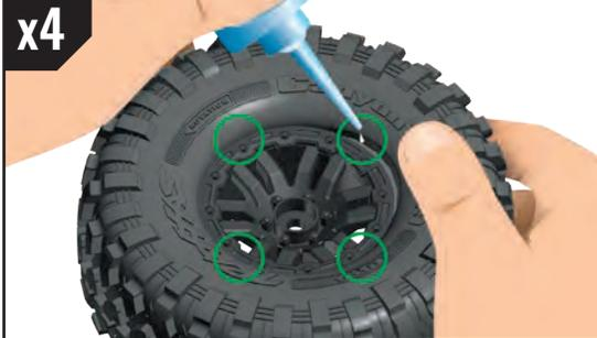
*Kleben Sie die Reifen auf die Räder. Drücken Sie mit Ihrem Daumen die Seite des Reifens von der Felge weg. Wiederholen Sie dies an vier Punkten am Umfang des Rads. Drehen Sie das Rad um und wiederholen Sie die obigen Schritte an der Innenseite des Rads.*
